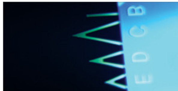
AFM mikroskopiaren punta. Bertan proteinak itsasten dira eta mekanikoki tenkatu daitezke.
