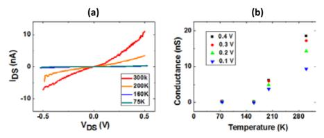
Figura 4. (a) Corriente del canal y (b) conductancia. Por debajo de 200K, el mecanismo de transporte sufre una transición de transporte asistido térmicamente a túnel independiente de la temperatura.
