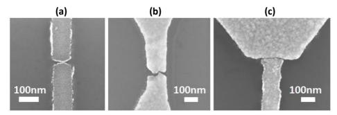
Figura 1. Uniones túnel realizadas por métodos de (a)EBL, (b)EM and (c) Proyección
