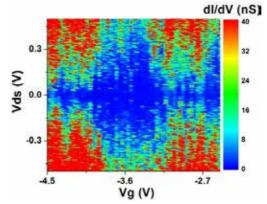
Figura 3. Diagrama de estabilidad de un transistor de un solo electrón a temperatura ambiente; creado por electromigración de un hilo de Ni<sub>80</sub>Fe<sub>20</sub>.
